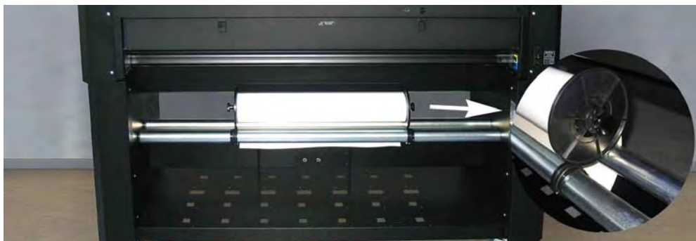
FIG 1-11 LE SYSTEME DEROULEUR DE MEDIA DE LA DC4SX
