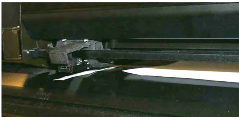
FIG 5-1 NETTOYAGE DES MANCHONS
