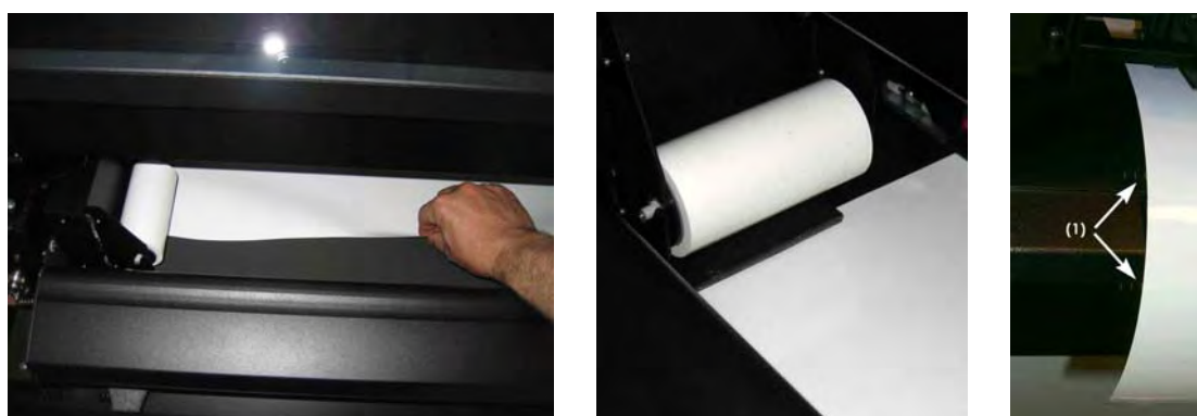
FIG 1-13 CHARGEMENT DU MEDIA COTE FACE DE LA DC4SX
